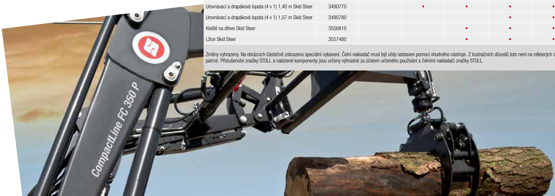
Výkyvné rameno FC-H bez paralelního vedení (paralelogram)
