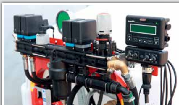
Blok elektrozaworów z możliwością podłączenia komputera
