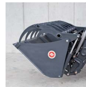
2 Zaklopení nářadí – zajišťovací mechanismus se automaticky zacvakne
