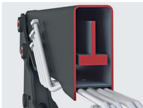
Průřez ramene výložníku – uvnitř je uloženo ovládací táhlo, pod ním hydraulická vedení.
