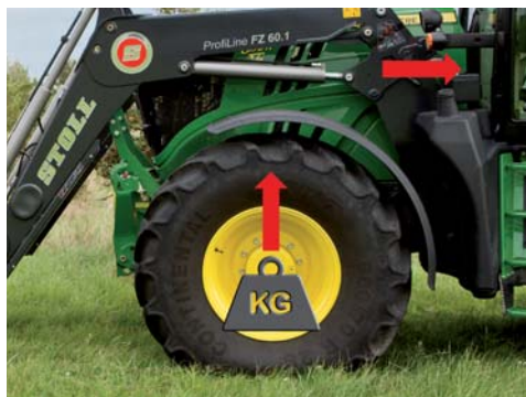
Konzoly přiléhají těsně ke kabině řidiče – tím se odlehčí přední náprava traktoru.
