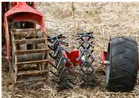
Na výběr jsou tři utužovací válce: prutový, dvojitý „V“ prstový nebo Farmflex
