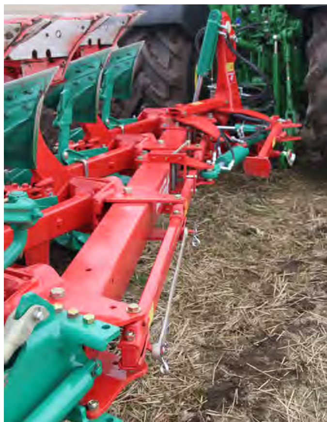
Pohled na rám pluhu Kverneland 150 S Variomat. V přední části pluhu je paměťový válec a hydraulické nastavení záběru první radlice
