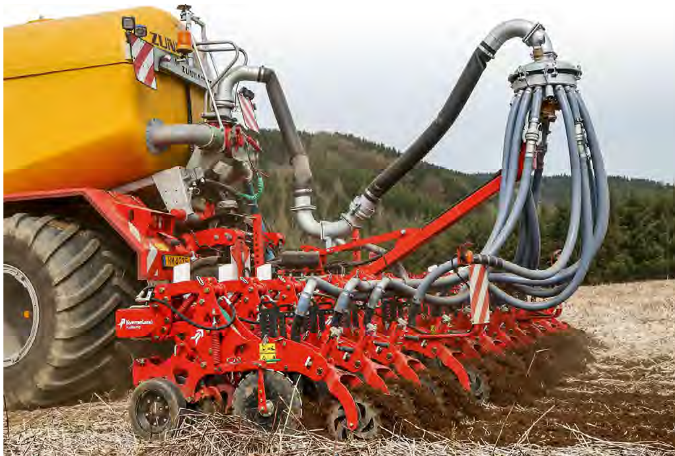
Sklápěcí Kultistrip s pracovním záběrem šest metrů je schválen až pro 650 koní.
