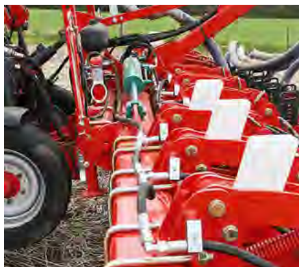
Dvojitý rám uprostřed přenáší síly od bočních křídel sklopného provedení rámu
