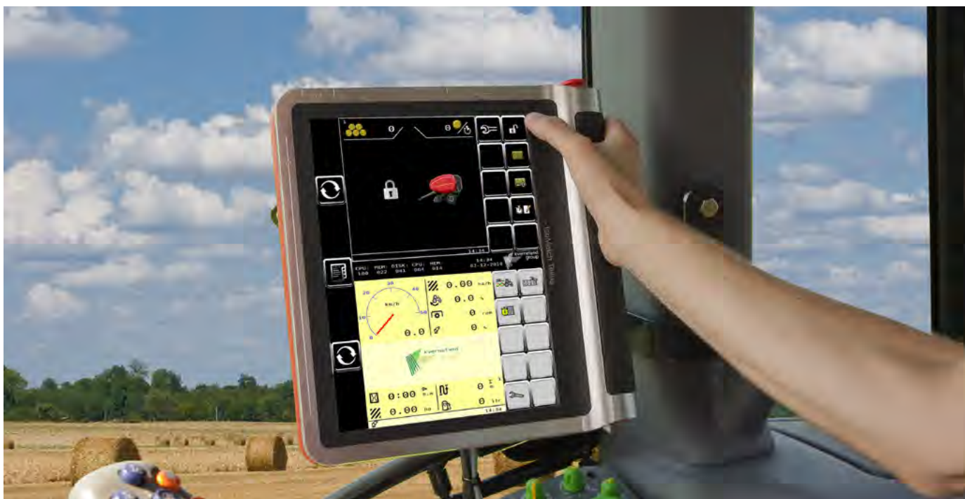
Isobus kompatibilní terminál IsoMatch TELLUS s dotykovou obrazovkou rozdělenou na dvě části a ergonomickou opěrou ruky pro usnadnění práce za jízdy.
