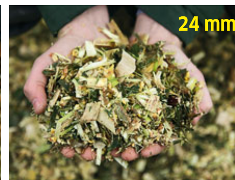
Kvalita řezanky při našem testu stroje BiG X 700 s bubnem MaxFlow s 36 noži, VariLOC a diskovým drtičem zrna při nastavené teoretické délce řezanky 4 mm (vlevo), 14 mm (uprostřed) a 24 mm (vpravo). Zrna kukuřice byla v každém případě dobře rozdrčena. Foto: Eikel, Werkbild (1).
