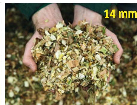
Kvalita řezanky při našem testu stroje BiG X 700 s bubnem MaxFlow s 36 noži, VariLOC a diskovým drtičem zrna při nastavené teoretické délce řezanky 4 mm (vlevo), 14 mm (uprostřed) a 24 mm (vpravo). Zrna kukuřice byla v každém případě dobře rozdrčena. Foto: Eikel, Werkbild (1).
