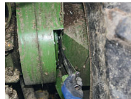
VariLOC se přepíná běžným otevřeným klíčem č. 36.
