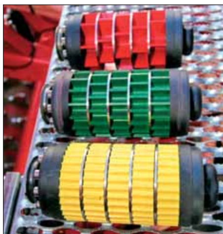
Elektrické dávkovanie so signálom rýchlosti podľa GPS a tri výsevné valčeky pracovali dobre.
