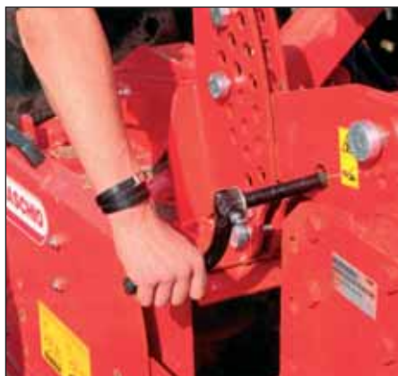
... ako centrálne prestavenie urovňavacej lišty (nastavovacia stupnica je však len nalepená).
