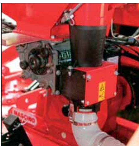
Elektrické dávkovanie so signálom rýchlosti podľa GPS a tri výsevné valčeky pracovali dobre.
