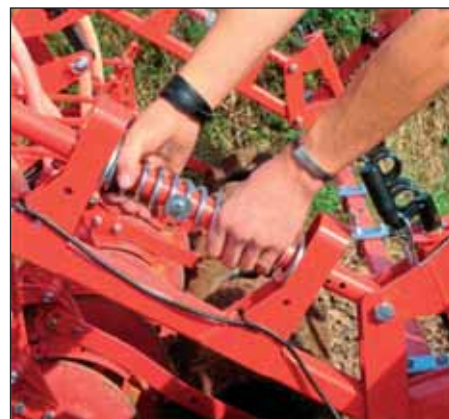
Na nastavenie prítlaku zavlačovačov radšej, nie ako tu, použite rukavice.
