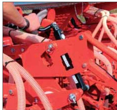
S dvoma vretenami sa nastavuje sklon nosníka výsevných pätiiek a teda aj hĺbka sejby.
