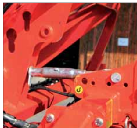
Pri plnom zásobníku sa sejačka tlačí dopredu, pričom vrchný bod závesu klesá.
