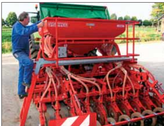
Cez dlhé schody a dobrú plošinu dosiahnete na rozdeľovač v zásobníku.
