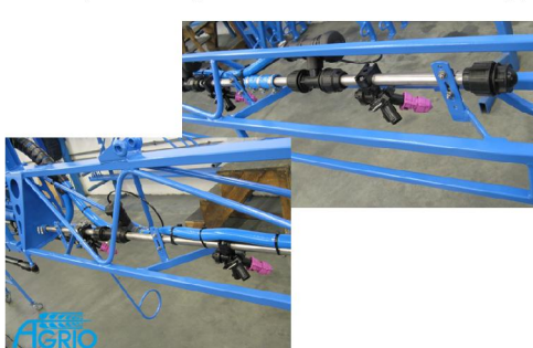
Rozvody z nerez (plastové křehnou nebo bobtnají)
