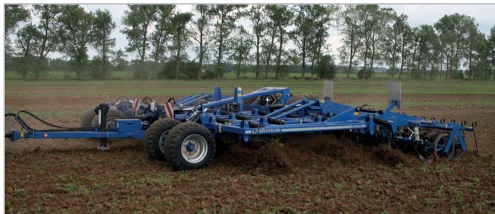
Podmítač Vector s pracovním záběrem osm metrů a nejužšími dláty, širokými pouhé 4 cm, při hlubokém kypření Foto archiv redakce
