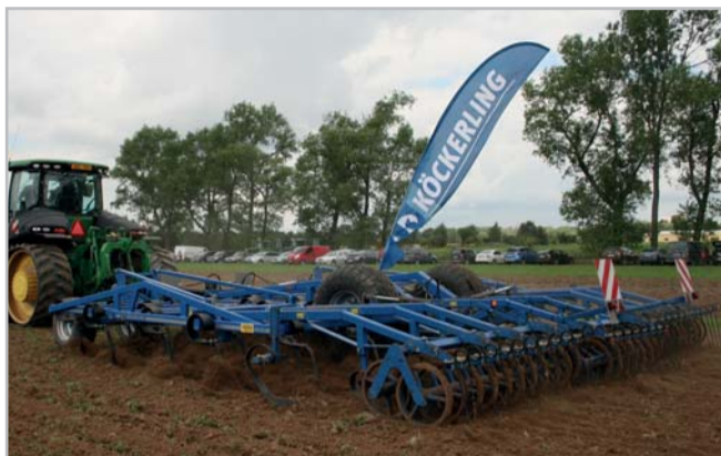
Kypřič Vario s pracovní šířkou 7,5 m za pásovým traktorem John Deere 9560 RT. Dláta široká 6 cm jsou vhodná pro narušení povrchu pole a větší hloubku zpracování Foto archiv redakce
