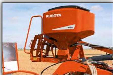
Zásobník osiva SH200 alebo SH500 s objemom 200 alebo 500 litrov na sejbu medziplodín jedným prejazdom počas spracovania strniska.
