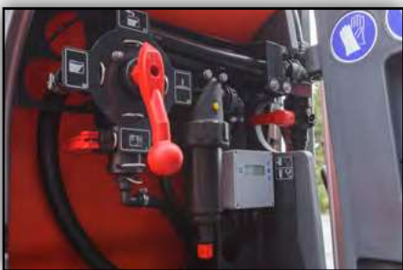
Ovládací panel Easy Set uľahčuje život vďaka intuitívnemu ovládaniu. Dva samostatné ventily - jeden sací a jeden tlakový.
