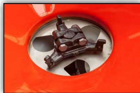
Čuchrač zaisťuje rovnomerný tok hnojiva.
