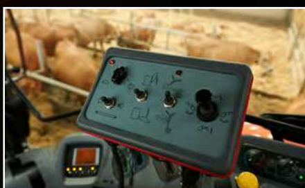
Ovládací box je ľahko zvládnuteľný terminál so zameraním na funkčnosť a jednoduchosť. Poskytuje plnú kontrolu nad všetkými funkciami z kabíny traktora.
