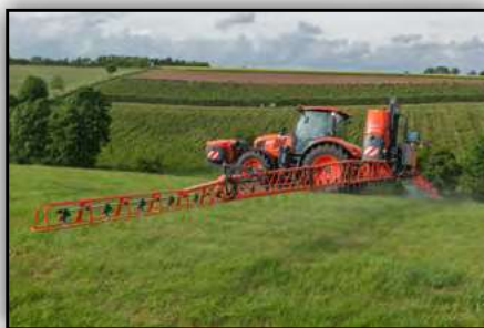
Boom Guide - ISOBUS kompatibilný postrekovač s ultrazvukovým vyrovnávaním ramien.
