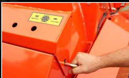
Jednoduché prepínanie od nastielania ku kŕmeniu, dvojjstupňová prevodovka.
