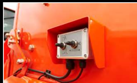
Okrem diaľkového ovládania možno ovládať vráta a reťazový dopravník dna prídavným páčkovým ovládaním umiestneným na boku stroja.
