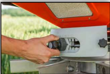
Nastavovací mechanizmus FlowPilot umožňuje jednoduché a presné nastavenie aplikačnej dávky.
