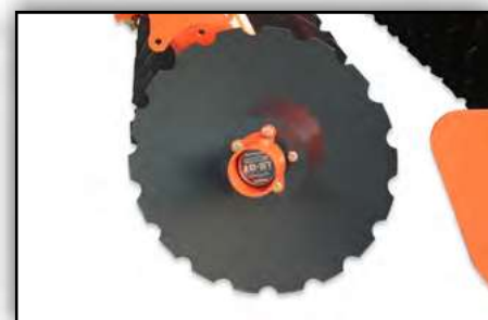
Taniere majú kónický tvar, ktorý zaisťuje konštantný uhol rezu nezávisle od priemeru kotúča. K dispozícii sú dva taniere: jeden s malým vykrojením a nový taniere s veľkým a malým vykrojením pre lepší samočistiaci účinok v pôde s viac ako 20% ilu.
