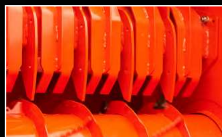
Systém DFCS zabraňuje zahlteniu metacieho ústrojenstva pri rozbehu stroja. Až keď sa metacie koleso roztočí do optimálnych otáčok, stlačíte gombík a hrebeň DFCS sa postupne presunie do hornej polohy a otvorí plný priechod materiálu k rozdrúžovaciemu bubnu a metaciemu kolesu. Tak je zabezpečený plynulý rozbeh stroja pri štarte a minimalizované riziko zablokovania stroja.
