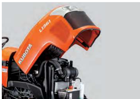
Vysúvacia mriežka chladiča / Kapota otváraná teleskopickou vzperou
