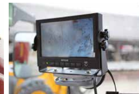
Monitor pro couvací kameru
