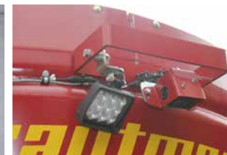
Couvací kamera & reflektor
