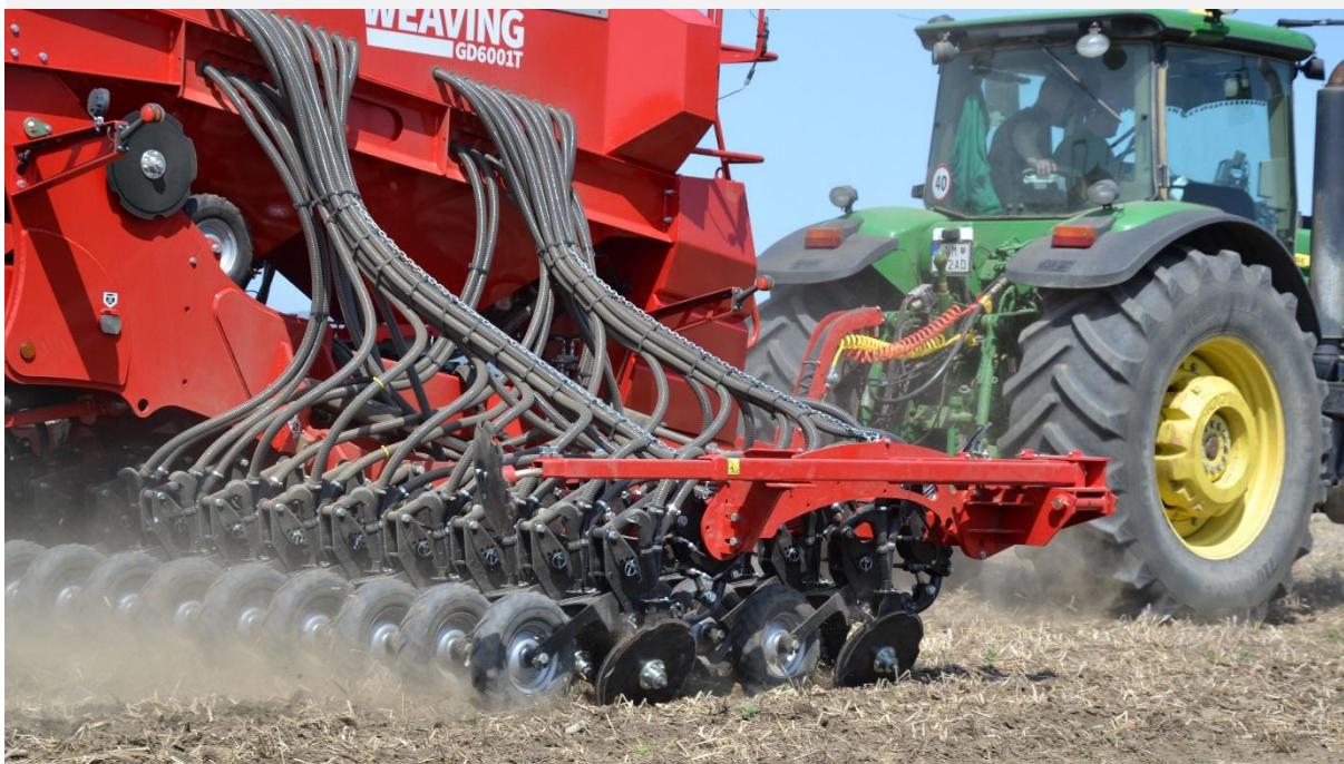
WEAVING GD6001T - dvě výsevní ústrojí plus mikrovýsev. Šlachtiteľská stanica Horná Streda.
