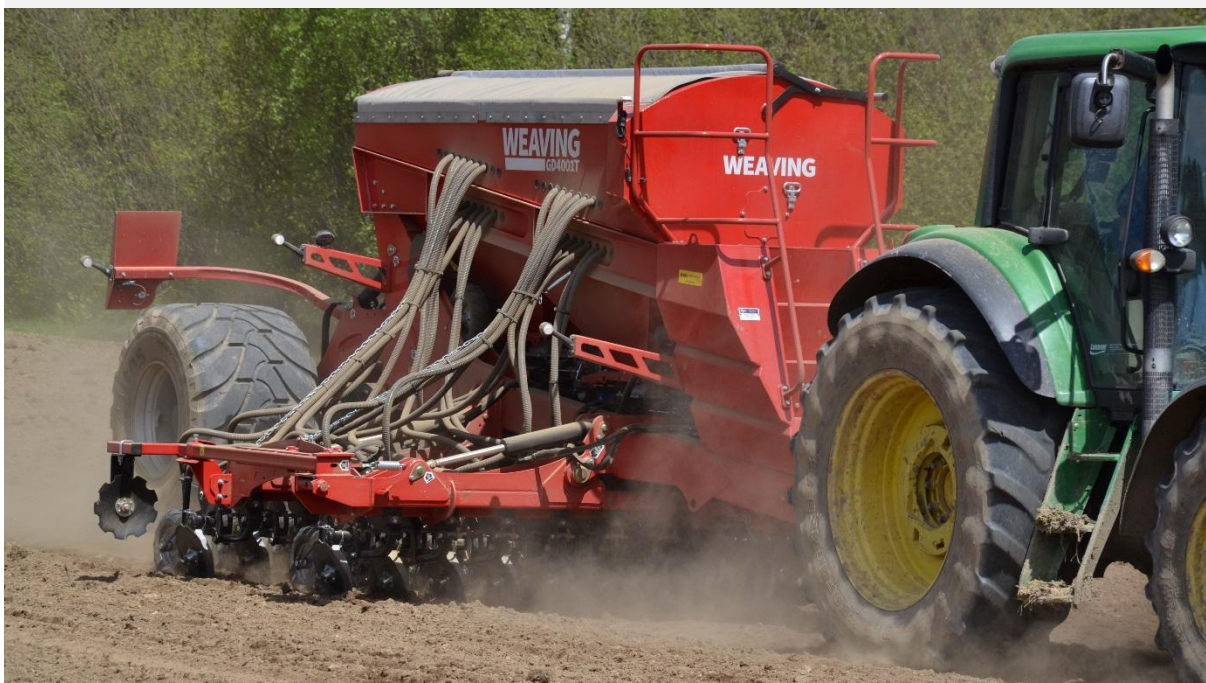
WEAVING GD4001T - dvě výsevní ústrojí plus mikrovýsev. ZD Ráčov u Jihlavy.
