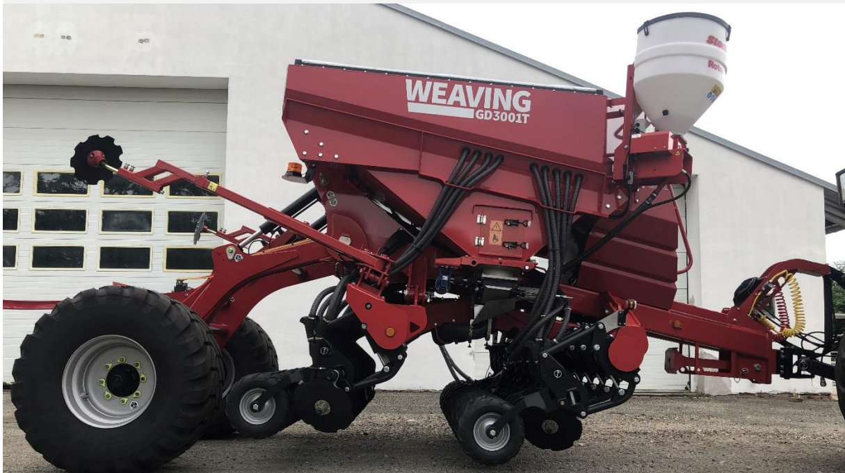
WEAVING GD3001T - dvě výsevní ústrojí plus mikrovýsev. Ing. Přikrylová, Rybníček u Vyškova.
