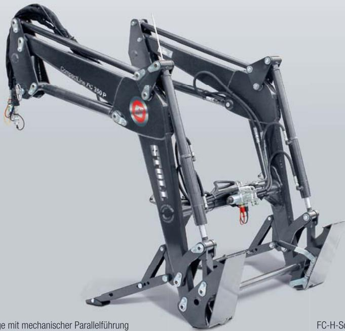
FC-P-Schwinge mit mechanischer Parallelführung
