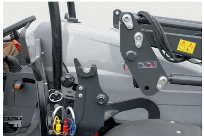
Mit wenigen Handgriffen wird der Frontlader abgestellt. Per Steuergerät wird die Anbausäule aus dem Anbauteil herausgeschwenkt, die Abstellstützen herabgelassen und die Hydraulik abgekoppelt.
