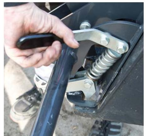
**3** Beidseitig zu bedienende Werkzeugverriegelung
