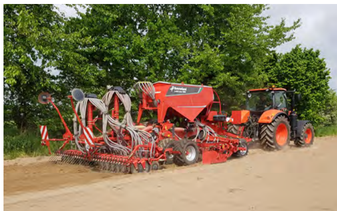
Dobre známy univerzálny sejací stroj Kverneland u-drill novo s pracovným záberom 4 m
