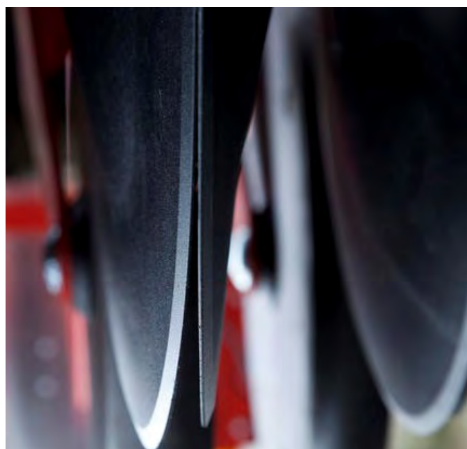
Uhol zvieraný kotúčmi výsevnéj pätky činí iba 8°. Je tak podstatne znížený potrebný prítlak na pätku aj ťahový odpor.
