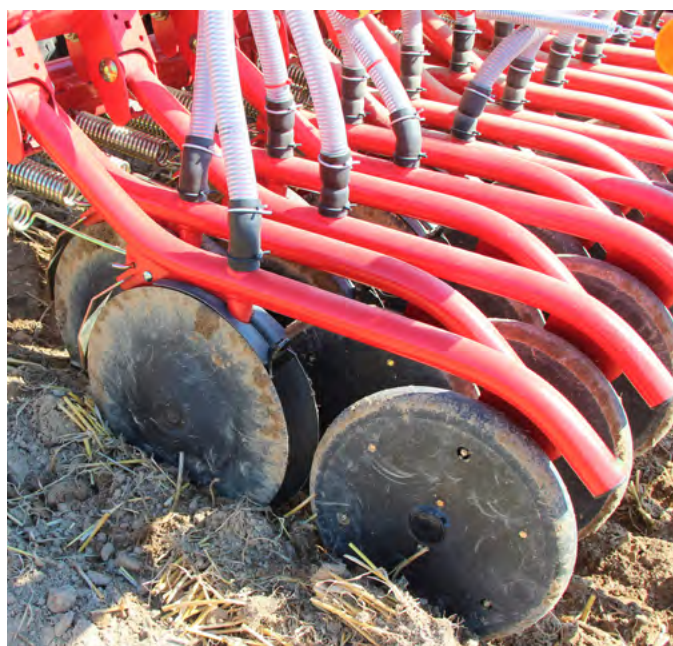
Robustné výsevné bodky CD vynikajú presnosťou ukladania osiva, pevnosťou a dlhou životnosťou.
