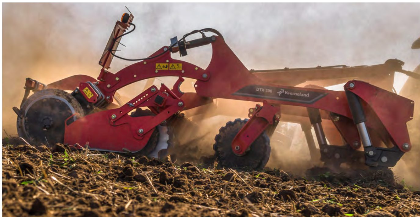
Kyprič Kverneland DTX umožňuje počas jedného prejazdu hĺbkové kyprenie a zároveň spracovanie strniska alebo osivového lôžka
