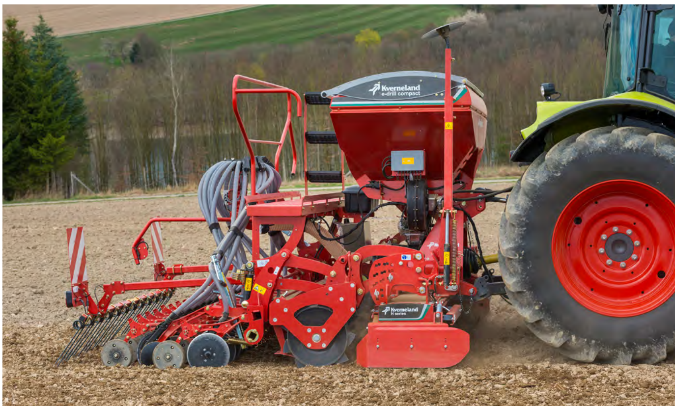
Sejačka Kverneland e-drill vyniká ťažiskom veľmi blízko závesu, je tak znížená potreba zdvihovej kapacity traktora
