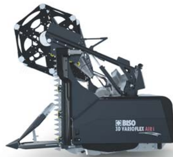
KOMBINACE DĚLIČE A KOSIČKY VÝBORNÉ PRO PROPLETENÉ POROSTY
