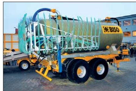
Cisternová nadstavba T15 s hadicovým aplikátorom
