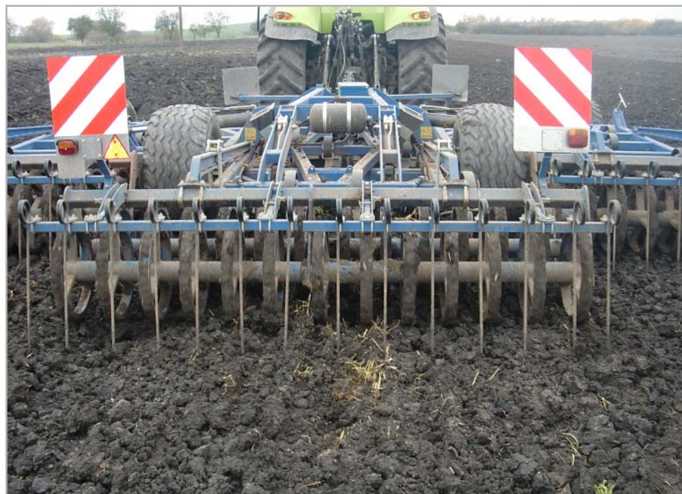
Následný STS válec rozdrtil vzniklé hroudy a zpětně utužil seťové lůžko. Tam, kde ostatní kompaktoři končili kvůli zalepeným válcům, Allrounder pracoval dál
