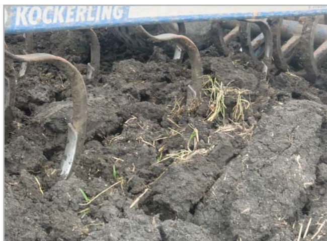
I za těchto podmínek sekce kypřících hrotů dostatečně prokypřila mokrou a těžkou vrstvu ornice a vytvořila drobtovitou strukturu
