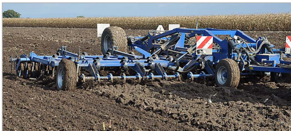
Ke kvalitní předseťové přípravě půdy, popřípadě k velmi mělké podmitce, je vhodný kombinátor Köckerling Allrounder
