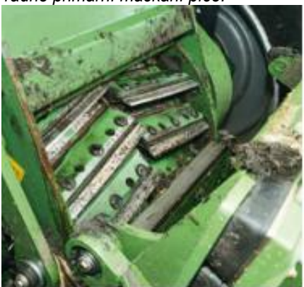
U nového bubnu s větším dopravním objemem sedí nože pod držáky.
