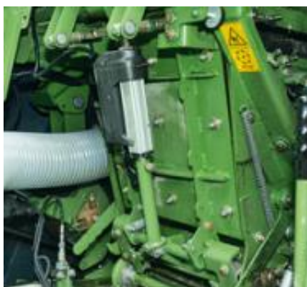
Pomocí servomotoru a klapky je možné zvýšit metací výkon při prosekávání.
