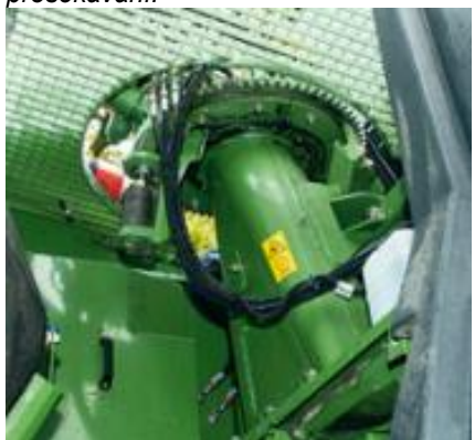
Stabilní otočný mechanismus s mechanickou nájezdovou pojistkou otáčí věží až o 210°.
