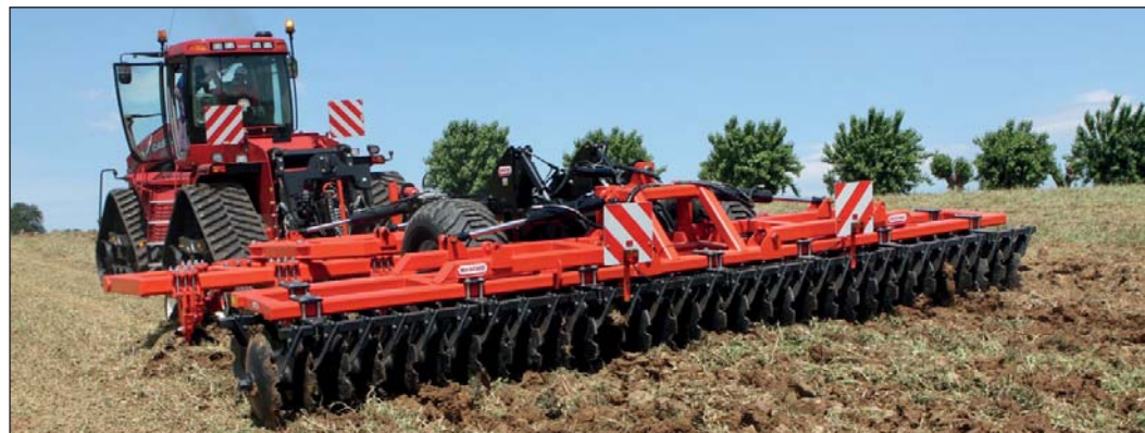
Hloubkový kypřič Diabolo s pracovními záběry 5, 6 a 7 m je určen pro traktory s výkonem od 450 koní
